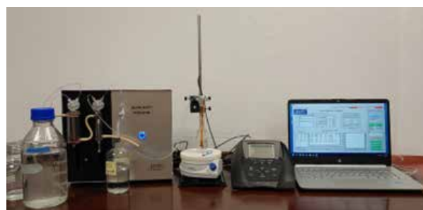
图2. LI-5800A 总碱度TAIk滴定仪测量工作台
