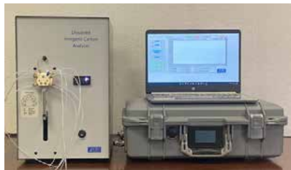
图1. LI-5300A 总溶解性无机碳DIC分析仪前视图: 多通道取样器; LI-7815 高精度 \text{CO}_2/\text{H}_2\text{O} 分析仪 (电脑下方)
