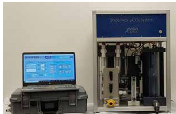
图1. LI-5400A 走航式二氧化碳分压pCO 2 测量系统
